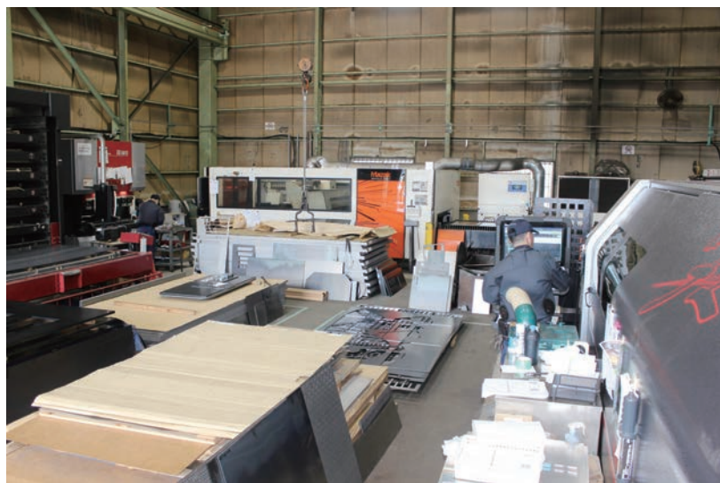
ワークを取り囲むように奥にはCO 2 レーザー加工機やプレスブレーキが配置
